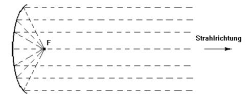
Durch die parabolische Form des Reflektors ist gegeben, daß alle vom <u>Brennpunkt</u> (Fokus) ausgehenden Wellen so refektiert werden, daß sie in der Hauptstrahlrichtung <u>parallel</u> und <u>phasengleich</u> verlaufen.
